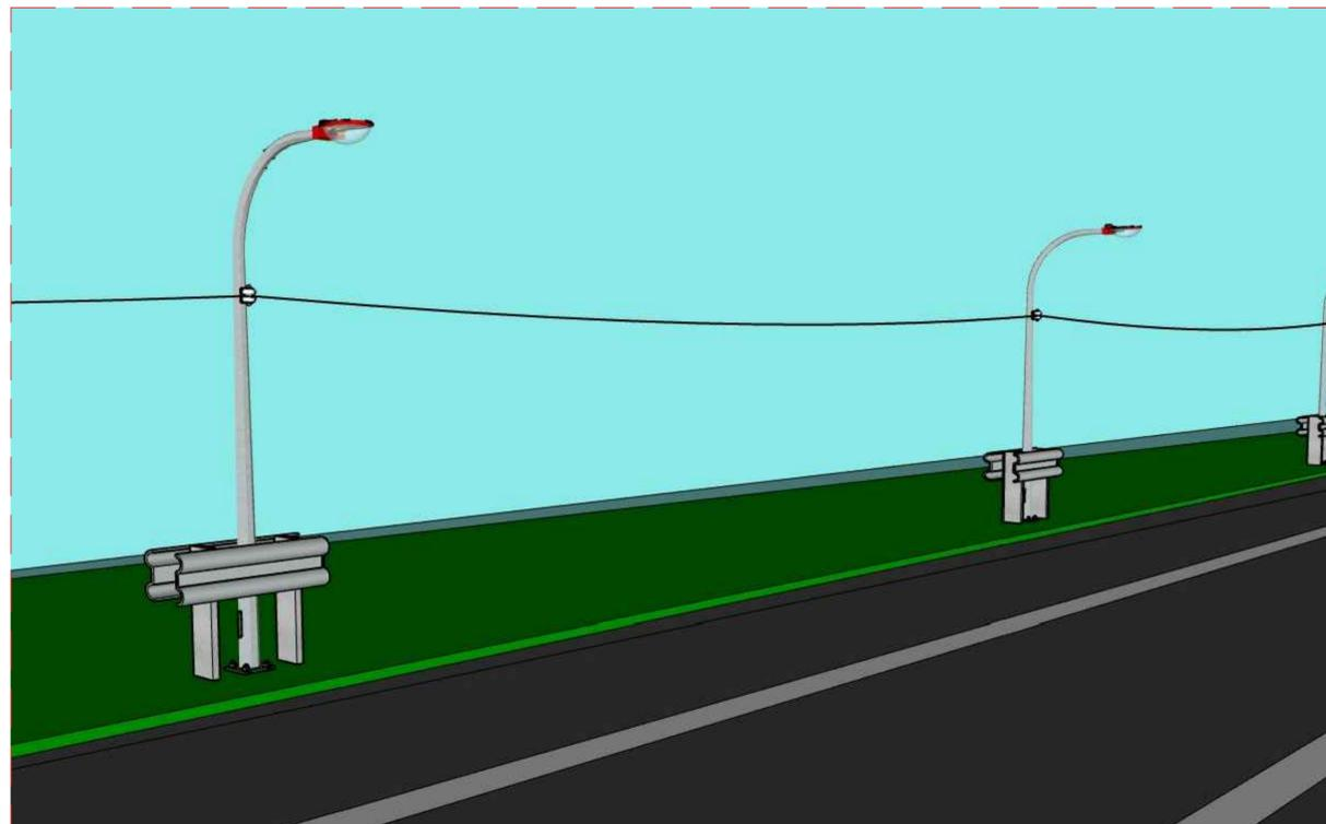
PROJEÇÃO DE POSTE METÁLICO EM CANTEIRO CENTRAL COM PROTEÇÃO S/ESCALA
