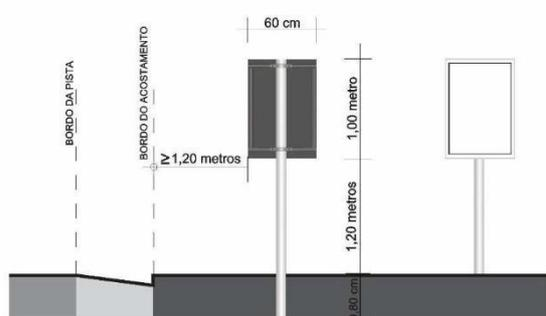
Figura 3: Modelo 03 - Diâmetro 0,60cm
