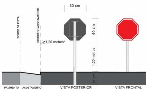
Figura 4: Modelo 04 - Diâmetro 0,60m
